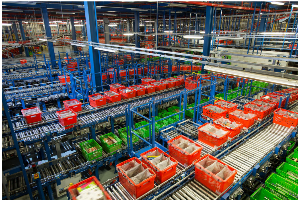
Abbildung 4 : Automatisierte Anlage (von Ocado). Quellbehälter in grün, Zielbehälter (rot) mit drei Tüten.[2]
